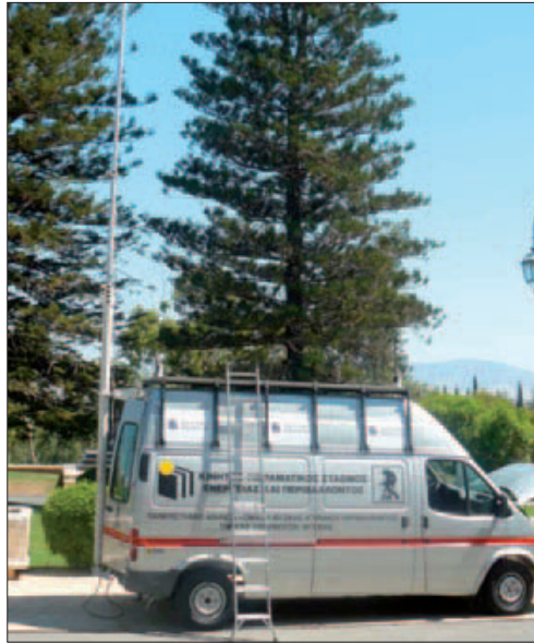
Ο Κινητός Σταθμός Μετρήσεων, με υπερούχρονη οργανολογία, που αποτύπωσε την υφιστάμενη κατάσταση του μεγάρου.
