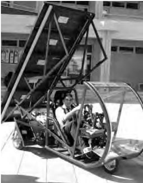
Τα ηλιακά πλαίσια που χρησιμοποιούνται για τη φόρτιση των μπαταριών των οχημάτων είναι τα ίδια περίπου πλαίσια που χρησιμοποιούνται για την παραγωγή ρεύματος. Με τη διαφορά ότι το ηλιακό πλαίσιο σε ένα Ι.Χ. παίρνει το σχήμα του οχήματος, συνήθως της οροφής. Στη φωτογραφία ηλιακό όχημα που θα λάβει μέρος στο διαγωνισμό.
