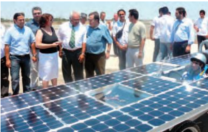
Το ηλιακό αυτοκίνητο χρησιμοποιεί ως κινητήρια δύναμη την ηλιακή ενέργεια και στις περισσότερες περιπτώσεις έχει αεροδυναμικό αμάξωμα που αποτελείται από κυψελωτές αλουμίνιο και υλικό από ίνες άνθρακα. Διαθέτει περίπου 900 κιλά ηλιακά στοιχεία, σε σωτιούκτες που βρίσκονται στην οροφή και στο πίσω μέρος του αυτοκινήτου. Τα ηλιακά στοιχεία συγκεντρώνουν τη φωτεινή ακτινοβολία σε ηλεκτρική ενέργεια, που τροφοδοτεί έναν ειδικού τύπου κινητήρα. Στη φωτογραφία ηλιακό όχημα κυπριακής κατασκευής που θα συμμετάσχει στο διαγωνισμό.
